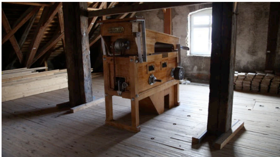
Abb. 44: Mahlputzmaschine von Bühler (Foto: Denise Tonella)
